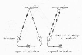
Fig. 7. — Représentation schématique d'une installation de détermination de position d'après le procédé de modulation d'impulsion. A gauche l'émetteur et le récepteur sont séparés, à droite l'antenne est commune.
