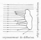
Fig. 3. - Diffusion d'une onde électro - magnétique par un objet irrégulier, dont les dimensions sont grandes par rapport à la longueur d'onde. Une par-tie de l'énergie diffusée est toujours renvoyée dans la direction de l'onde incidente.
