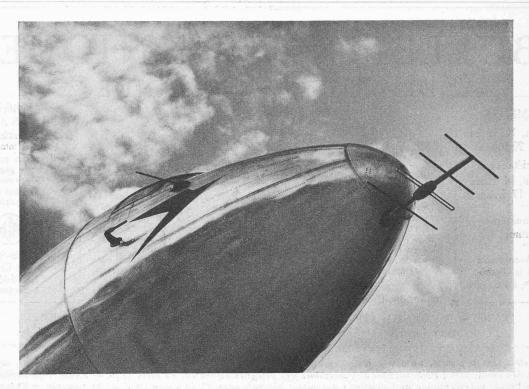
Fig. 1. — Antenne de Radar sur le nez de l'avion britannique de transport Avro Tudor I.
