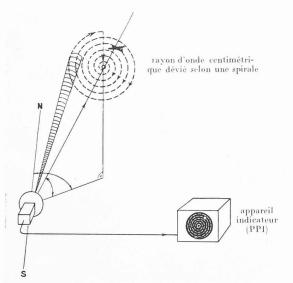
Fig. 12. — Représentation schématique du batayage en spirale d'un secteur à l'aide d'onde centimétrique. Le système d'antenne est commun pour l'émetteur et le récepteur et est entraîné par un dispositif électromécanique. A droite le tube indicateur à rayon cathodique dévié en spirale.
