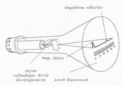
Fig. 8. — Emploi du tube à rayons cathodiques pour la mesure de distance. Le rayon cathodique se déplace de gauche à droite et est dévié verticalement lors de l'émission d'une impulsion et de la réception de l'écho.
