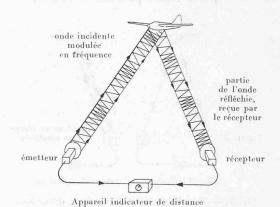
Fig. 5. — Représentation schématique d'une installation de détermination de position d'après le procédé de modulation de fréquence. L'émetteur et le récepteur sont séparés. La distance entre l'émetteur et le récepteur n'a pas besoin d'être grande.
