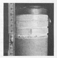
Essai sur quartz placée dans un cylindre com-posé d'anneaux superposés de 1 cm de hauteur. Noter la fissure. Epaisseur initiale 3 cm, finale  $\sim$  4 cm
