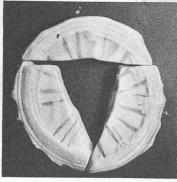
Fig. 14. — Fissures radiales (du type d) obtenues dans du kaolin.
