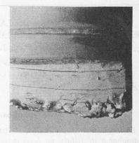
Détail de la figure 3. Noter les lentilles de glace et l'irré-gularité de la surface d'arrachement correspondant à la fissure.
