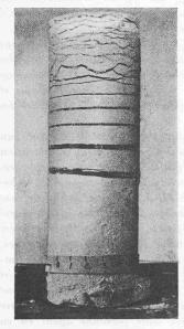
Fig. 1. — Lentilles de glace obtenues par Taber en 1930. L'échantillon était placé dans un cylindre continu en carton.
