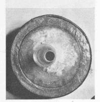
Fig. 20. — Discontinuité obtenue dans une suspension de bentonite contenant du sable grossier.
