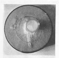
Fig. 17. — Corps hétérogène placé dans une suspension de bentonite, La fissure de 2 mm marque le con-tour de la zone gelée. Noter l'irrégu-larité de la surface gelée. (10 % bentonite).
