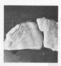
Fig. 7. — Essai de congélation d'une suspension de bentonite contenant des corps hétérogènes gélifs déjà feuilletés.
