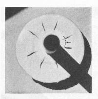
Fig. 10. — « Pierre morte ». Fissures de retrait radiales et centrifuges. Lentilles à 11 mm du tube ; limite du gel à 15,5 mm.  $W_L = 22,3 \% \qquad W_p = 21,4 \%$
