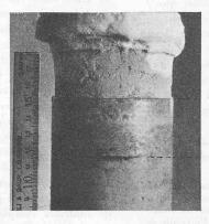
Gonflement obtenu au Laboratoire de Lausanne, sur échantillon dit « Pierre morte » placé dans un cylindre continu, lubrifié et transparent.
