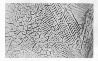
Fig. 13. — Texture typique d'une suspension de bentonite (coupe  $\bot$  au sens de propagation du froid). Les zones noires sont de la glace pure.
