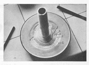
Fig. 6. — Vue générale du nouveau dispositif expérimental. 1, 2, 3, 4 : lentilles successives à 8 mm, 15-16 mm, 22 mm et 39 mm du tube (largeur de la  $2^{\rm me}$  lentille = 1 mm). — 5 : fissure de retrait radiale. — 6: limite d'influence. — 7 : limite du gel à 31 mm de la paroi extérieure du tube.
