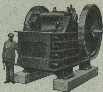
Concasseurs à balanciers simple ou double. — Concasseurs giratoires primaire ou secondaire. — Broyeurs à sable. — Machines à trier et laver le sable et le gravier. — Laveuses et Trieurs à inondation d'eau. Cribles vibratoires.
