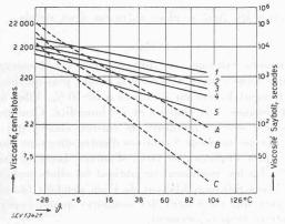
Fig. 2. Variation de la viscosité de fluides Silicones (1-5) et d'huiles minérales (A-C), en fonction de la température.
