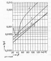
Fig. 3. Facteur de pertes tg ò en fonction de la température  $\theta$ .
