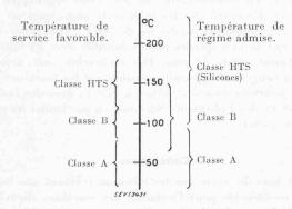
Fig. 6. — Température de régime admise pour les différentes classes d'isolants.
