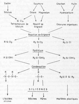
Fig. 1. — Représentation schématique de la préparation des Silicones.
