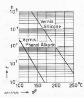
Fig. 5. « Vieillissement » t d'un vernis organique et d'un vernis silicone, appliqués sur un fil de cuivre, en fonction de la température θ (on a mesuré le temps qu'il fallait pour que le vernis montre des fentes après un allongement du fil de 3 %).
