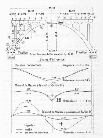
Fig. 19. — Essais sur le modèle en celluloïde.
