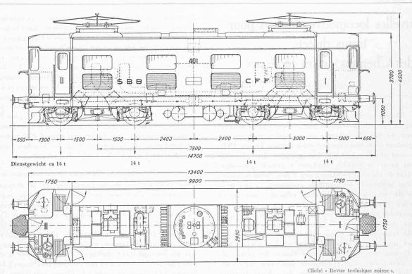
Fig. 2. — Caractéristiques générales de la nouvelle locomotive pour trains légers des Chemins de fer fédéraux.
