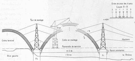
Fig. 12. - Schéma de montage d'un cintre.
