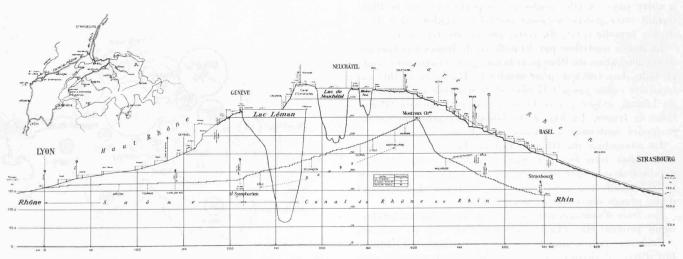
Fig. 27. — Voies navigables du Rhône au Rhin par la France et par la Suisse. Croquis de situation et profils en long comparatifs. A remarquer le grand nombre d'écluses et de paliers que présente le canal actuel, passant par l'Est de la France.
