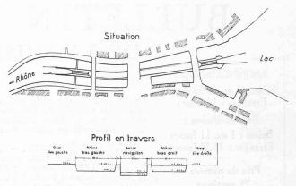
Fig. 25. — Liaison navigable du Rhône au Léman, par un canal à ciel ouvert, à niveau abaissé par pompages, projeté dans le lit du Rhône à Genève.
