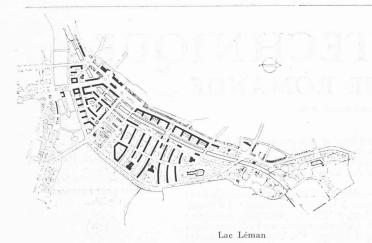
Fig. 24. — Liaison navigable du Rhône au Léman par un canal à ciel ouvert projeté à travers les quartiers de la rive droite, à Genève.
