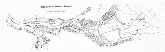
Fig. 23. — Correction projetée du Rhône à Genève, en vue de porter la capacité de l'émissaire du lac de 600 m³/sec environ, valeur actuelle, à 800 m³/sec environ.
