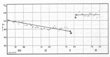
Fig. 14. — Variation du rendement journalier moyen de l'usine d'Innertkirchen, calculé d'après les lectures des compteurs de kWh et des débitmètres relevées en service (d'août à novembre 1944).
