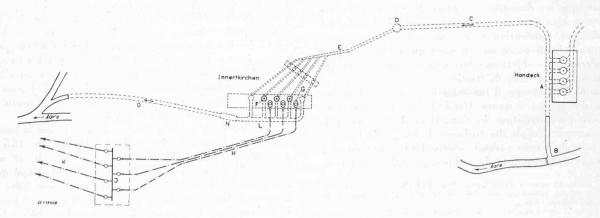
Fig. 1. — Représentation schématique des installations des usines de l'Oberhasli,
