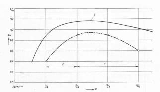
Fig. 9. — Rendement des turbines. pour n=428,6 t/min et H=670 m de chute. 1 Garantie. 2 Information. 3 Essais.  $P_{R}=43~000$  kW (58 400 PS).
