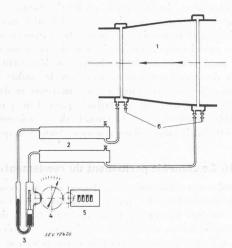
Représentation schématique du dispositif de mesure par venturimètre.
