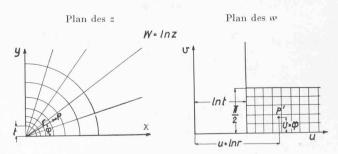
Fig. 4. — Détermination des lignes équipotentielles et des lignes de courant pour une vanne à bordage droit et à seuil horizontal.
