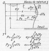
Fig. 2. — Calcul de la pression hydrostatique et de son point d'attaque.
