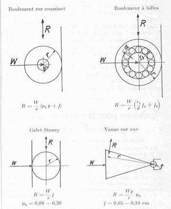
Fig. 7. — Résistance au frottement des appareils de roulement.
