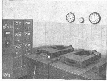
Vue partielle d'une installation de compteur de durée à signaux, pour un atelier de trempe. Le tableau de commande permet de régler à l'avance la durée d'opération prévue, avec signalisation acoustique ou lumineuse de fin d'exécution. Retour à zéro ou répétition automatique des signaux.
