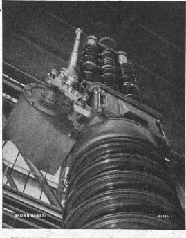
Pôle d'un disjoncteur pneumatique ultra-rapide de 220 000 V.
