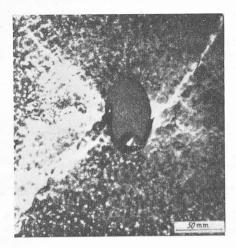
Fig. 26. — Modèle en parafine perforé d'une cavité elliptique. Remarquer les concentrations de pression sur les flancs et comparer avec la figure 21. — D'après Wiss. Abt. dtsch. Materialprüfunganst. — Berlin 1939.
