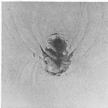
Fig. 29. — Formation d'une zone plastique et apparition de lignes de glissement.
