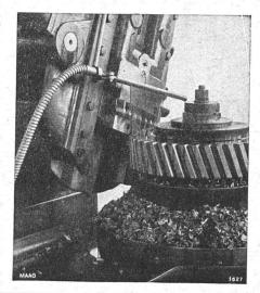
Livraison, usinage ou seulement taillage d'engrenages, de roues à chaîne et de roues à cliquet de tout genre et de toute grandeur.
