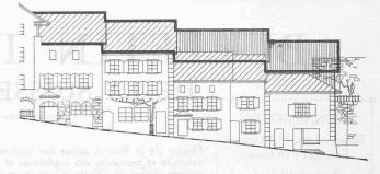
Fig. 3. — Plan d'extension cantonal. Façades. Tirait fort : gabarit maximum des toitures.
