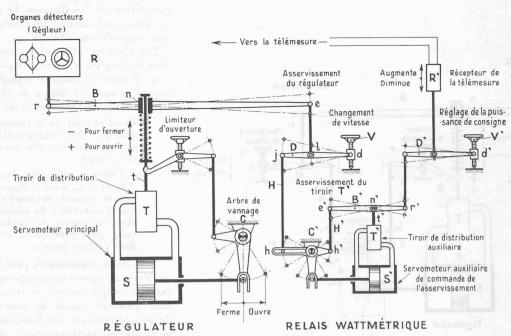
Schéma d'un régulateur de vitesse équipé en vue du réglage « fréquence-puissance ».
