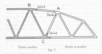
En effet, supposez que l'on ait soudé déjà une partie d'une poutre principale à treillis, par exemple celle de gauche de la figure 7. Le prochain nœud à réunir à la partie déjà terminée est le nœud A.
