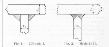
On réalise souvent cet assemblage suivant la méthode I (fig. 1), par deux soudures d'angle latérales qui laissent une interruption ou une faille intérieure approximativement de largeur  $e_2$  entre les deux pièces à réunir.
