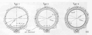
Fig. 6. - Profils-types de la galerie d'amenée.
