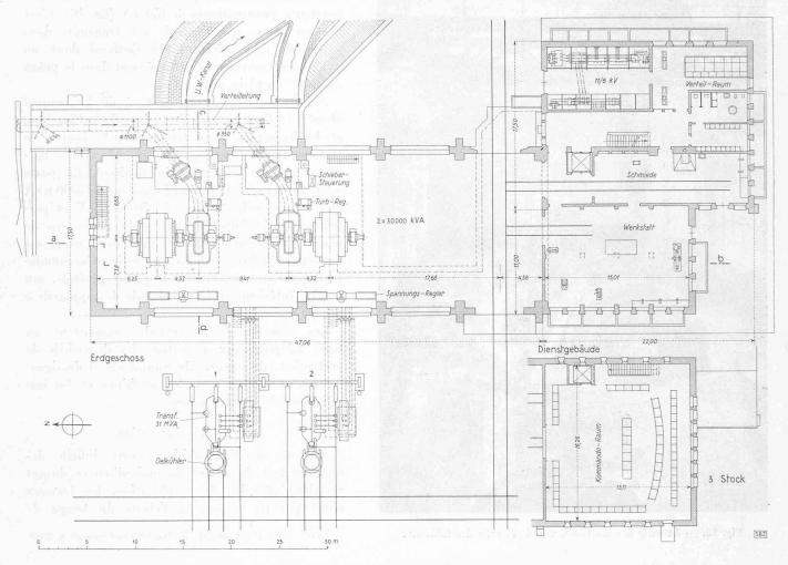
Fig. 10. — L'usine génératrice d'Airolo. Echelle 1 : 400.
