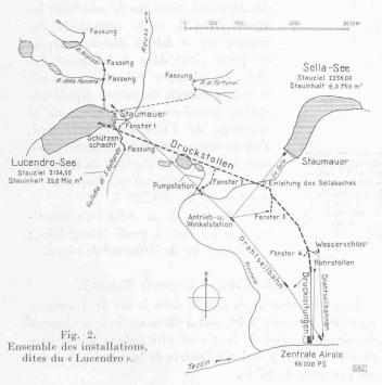
Légende: Stauziel = cote max. de la retenue — Stauinhalt = capacité utile — Staumauer = mur-barrage — Fassung = prise d'eau — Fenster = fenètre d'attaque — Wasserschloss = chambre d'équilibre — Rohrstollen = galerie blindée — Druckleitungen = conduites forcées — Drahtseilbahn = funiculaire ou téléférique — Pumpstation = station auxiliaire de pompage — Antrieb-u. Winkelstation = poste de commande du téléférique.
