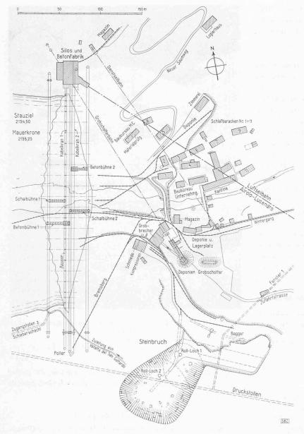
Fig. 3. — Chantier du barrage du Lucendro.
