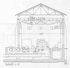
Fig. 11. L'usine génératrice d'Airolo. Coupe en travers : 1 : 400.
