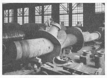
Fig. 9. — Le collecteur avec ses collerettes de renforcement.
