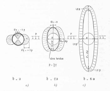
Fig. 22. — Influence de la forme de la cavité sur la répartition des contraintes périphériques. Calcul d'après Fenner en milieu élastique.
