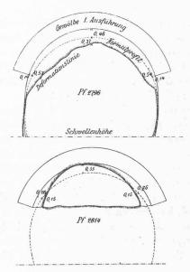
Fig. 4. — Tunnel du Saint-Gothard. Déformation du revêtement au km 2,796 et 2,814 deux mois après son exécution. D'après Dolezalek.
