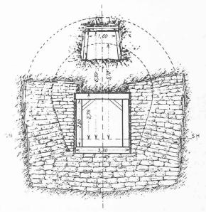
Fig. 6. — Tunnel du Simplon. Km 4,452 à 4,504. Exécution du revêtement renforcé autour de la galerie de base maintenue par des cadres en fers profilés. La voûte est attaquée plus tard par une galerie de faîte simplement boisée.
