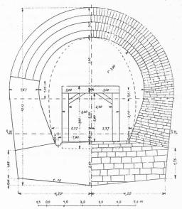
Fig. 7. — Tunnel du Simplon. Km 4,452-4,504. Revêtement renforcé.
