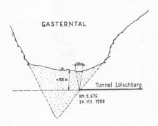
Fig. 12. — Effondrement de la galerie d'avancement du Lötschberg pénétrant dans les alluvions du « Gasterntal ». Remarquer la forme conique de la surface de rupture.
