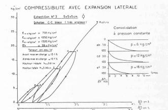
Fig. 15. — Courbe de déformation d'un schiste argileux provenant des assises du barrage de Beni-Bahdel. Les déformations permanentes atteignent 40 % des déformations totales.
