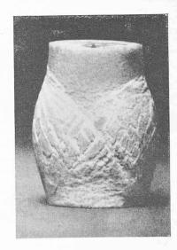
Fig. 16. — Déformation plastique d'un marbre sous triple étreinte d'après Ros et Eischinger. Diskussionstericht ETH No. 28.
