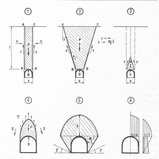
Fig. 17. — Différentes formes de rupture admises pour le calcul des poussées.
