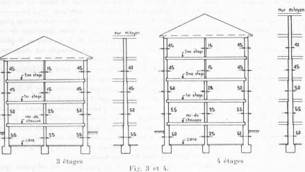
Fig. 3 et 4. — Exigences minimales pour la maçonnerie de bâtiments d'habitation.
