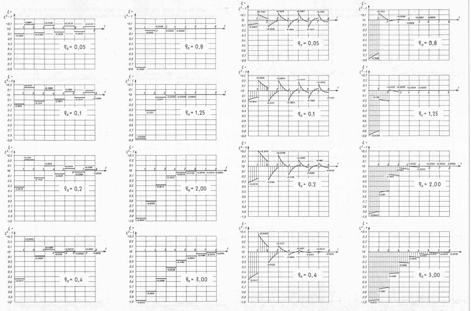
Fig. 9. — Conduite  $\sigma = 0$ . Ouverture brusque  $\theta = 0$ . Diagrammes des surpressions  $\xi(t)$  à l'extrêmité aval pour  $\rho_0 = 0.05$ , 0.1, 0.2, 0.4, 0.8, 1.25, 2.00 et 3.00.
