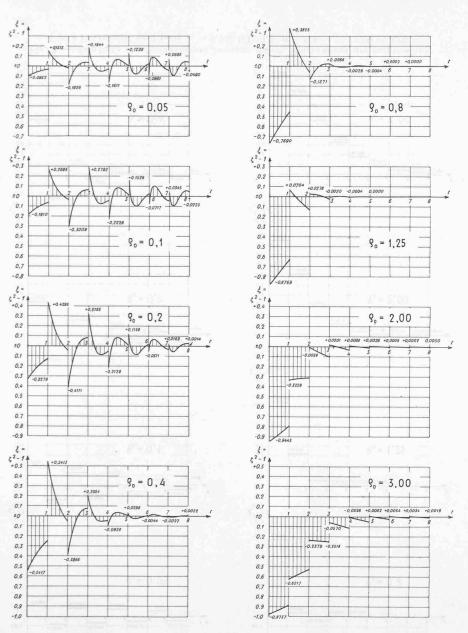
Fig. 11. — Conduites  $\sigma = 0.6$ . Ouverture brusque  $\theta = 0$ . Diagrammes des surpressions  $\xi(t)$  à l'extrêmité aval pour  $\rho_0 = 0.05, 0.1, 0.2, 0.4, 0.8, 1.25, 2.00$  et 3.00.
