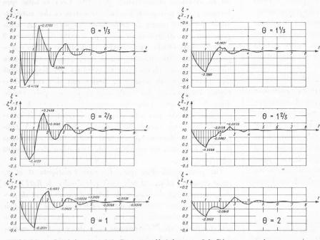
Fig. 22. — Conduites  $\sigma=0,6$ . Ouverture linéaire  $\rho_o=0,4$ . Diagrammes des surpressions à l'extrémité aval de la condeite pour  $\theta={}^1/_3,{}^2/_3,{}^1,{}^1/_3,{}^1^2/_3,{}^2,$
