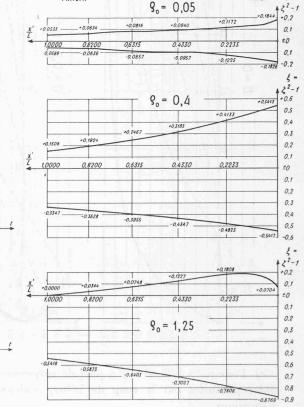
Fig. 21. — Conduite  $\sigma=0.6$  ( $v=0.135, \mu=0.400$ ). Ouverture brusque  $\theta=0$ . Valeurs extrêmes des surpressions le long de l'axe, pour  $\rho_0=0.05, 0.4$  et 1.25.
