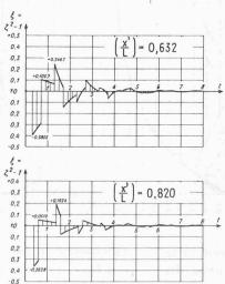
Fig. 20. — Conduite  $\sigma=0.6$ . ( $\nu=0.135$ ,  $\mu=0.400$ ) Ouverture brusque  $\theta=0$ . Diagrammes des surpressions  $\xi(t)$  aux profils  $\frac{x'}{L}=0.223$ , 0.433, 0.632 et 0.820 pour  $\rho_{\theta}=0.4$ .
