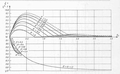
Fig. 19. — Ouverture brusque  $\theta = 0$ . Valeurs extrêmes des surpressions à l'extrêmité aval de la conduite en fonction de  $\rho_0$ , pour différentes valeurs de  $\sigma$  (synopsis cartésienne du coup de bélier d'ouverture brusque).
