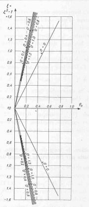
Fig. 24. — Fermeture brusque totale  $\theta=0$ . Valeurs extrêmes des surpressions à l'extrémité aval de la conduite en fonction de  $\rho_{\theta}$  pour différentes valeurs de  $\sigma$  (synopsis cartésienne du coup de bélier de fermeture brusque totale).
