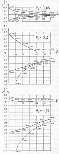
Fig. 23. — Conduites  $\sigma = 0.6$ . Ouverture linéaire. Valeurs extrêmes des surpressions à l'extrémité aval en fonction de la durée de la manœuvre  $\theta$ , pour  $\rho_0 = 0.05$ , 0.4 et 1.25 (traits continus).
