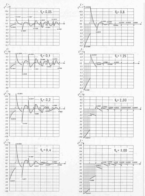
Fig. 12. — Conduite  $\sigma=1,0$ . Ouverture brusque  $\theta=0$ . Diagrammes des surpressions  $\xi(t)$  à l'extrêmité aval pour  $\rho_0=0,05,\ 0,1,\ 0,2,\ 0,4,\ 0,8,\ 1,25,\ 2,00$  et 3,00.
