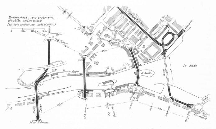
Fig. 5. — Circulation motorisée à Genève telle qu'elle résulte de la solution proposée.
