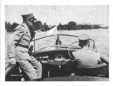
Ce canot patrouilleur de la police municipale de Zurich est équipé d'un émetteur à ondes ultra-courtes et d'un récepteur à ondes courtes. De ce fait le chef de patrouille peut se mettre à tout moment en communication dans les deux sens avec le poste de commandement.
