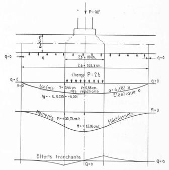
Fig. 3. — Poutre de longueur illimitée.
