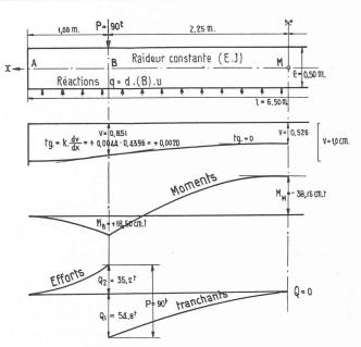
Fig. 2. — Charges symétriques d'une poutre de longueur limitée.
