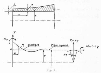
Pour fixer les idées, choisissons un tube suivant les caractéristiques représentées par la figure 2 ci-contre avec une épaisseur croissante. Fixons des axes de coordonnées à l'origine du tube ainsi que représenté par la figure 3. La fibre moyenne du tube se déforme sous l'effet du moment  $M_o$  et de l'effort tranchant radial T; elle prend la forme dite l'« élastique » du tube et qui a le caractère représenté ci-dessus.
