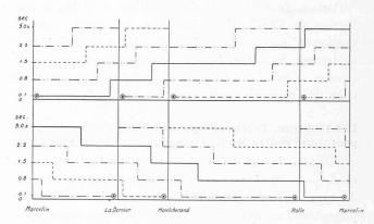
Fig. 13. — Garactéristiques « Temps-distance » des relais de distance du réseau à 40 kv de la Compagnie vaudoise.
