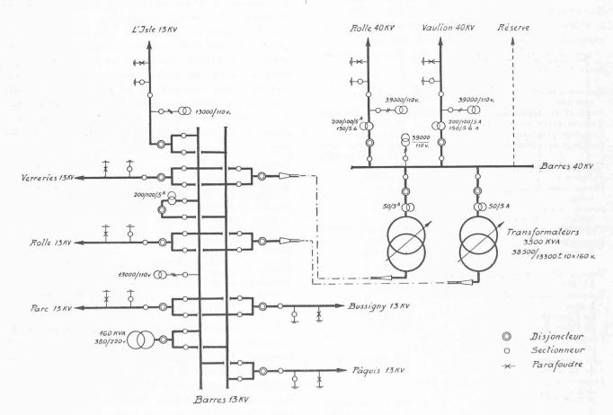
Fig. 5. — Poste de Marcelin. — Schéma à haute tension.
