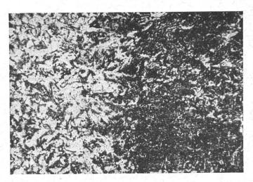
Microphotographie de deux couches de soudure.
