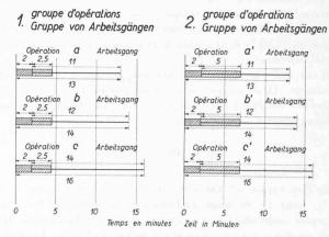
Fig. 7. — Exemples d'opérations exécutées simultanément sur trois machines.
