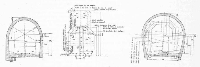
Fig. 9. — Ancien profil en travers dans une courbe de 40 m. de rayon, profil d'espace libre et nouveau profil en travers en courbe de 80 m.
