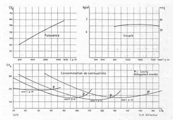
Fg. 6. — Puissance, couple et consommation spécifique de combustible du moteur. (Essais de réception du 8 mars 1941.)
