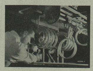
Réglage d'un émetteur à ondes courtes de 10 kW.
