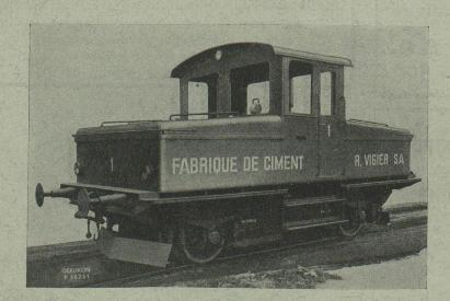
Locomotive à accumulateurs avec équipement électrique Oerlikon.
