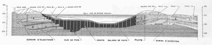
Fig 10.. — Coupe en long suivant l'axe du barrage et les écrans principaux.
