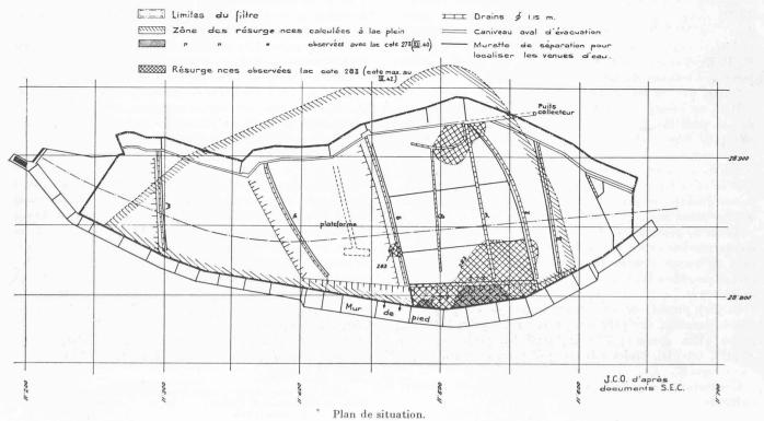
Fig. 15. — Observation des zones de résurgence des pertes.
