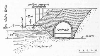
Fig. 11. — Centrale souterraine de Cotilia, Coupe en travers schématique.
