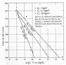
Fig. 8. — Résultats d'essais triaxiaux sur un sable
