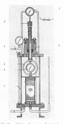
Fig. 3. — Schéma d'un appareil triaxial.
