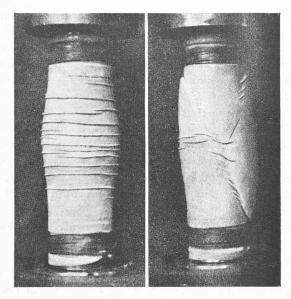
Fig. 5. — Rupture d'échantillons sableux dans l'essai triaxial.
