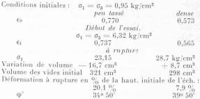
Fig. 4. — Résultats d'un essai triaxial sur un sable. (Trait plein = sable dense; pointillé = sable peu tassé).
