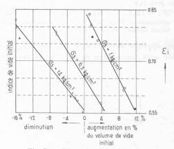
Fig. 7. — Détermination de l'indice de vide critique.
