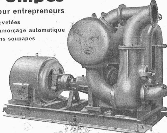
Hauteur d'aspiration jusqu'à 9 mètres, débits de 1 à 500 litres/ seconde. — Pas de soupape de pied, ni de clapet dans la tubulure d'aspiration. Aucune pompe à vide de secours. — Réamorçage automatique immédiat, même si de l'air est entré dans le tuyau d'aspiration. — Pas d'organes présentant des frottements et s'usant, par conséquent insensibilité à l'action des schlamms, du sable et des graviers.
