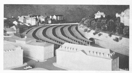
Fig, 4. — La nouvelle disposition des quais et des voies de la gare de Berne, vue du nord-ouest.
