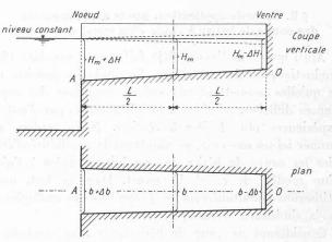
Fig. 7. — Canal découvert de profil rectangulaire dont la largeur et la profondeur varient linéairement.
