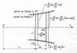
Fig. 4 b. — Mouvements non-permanents d'un liquide dans une conduite forcée à caractéristiques variables le long de l'axe.
