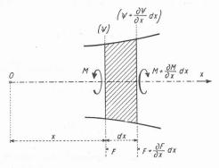
Fig. 3. — Vibrations de torsion d'une barre hétérogène d'axe rectiligne et de profil circulaire variable.
