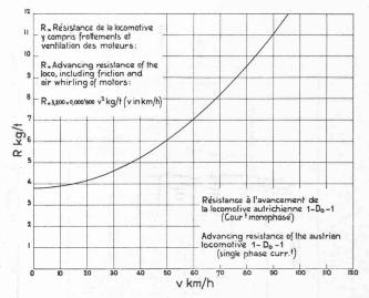
Fig. 24. Résistance à l'avancement de la locomotive 1-D<sub>0</sub>-1 des Chemins de fer autrichiens.
