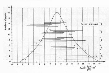
Fig. 31. — Valeurs de la constante apparente  $K_a$  calculée d'après les essais de Vernayaz et courbe statistique correspondante.
