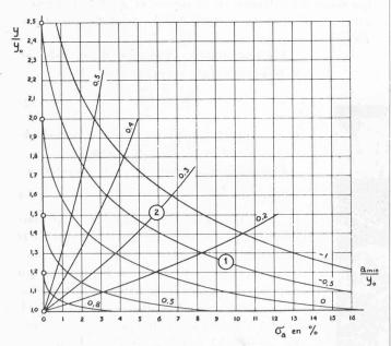
Fig. 26. — 1. Courbes donnant le rapport  $\sigma_o$  de la puissance extérieure à un rayon  $y:y_o$  à la puissance totale dans la section considérée, pour différentes valeurs de  $a_{min}:y_o$ .
