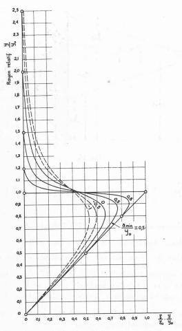
Fig. 25. — Distribution de la puissance hydraulique dans une section quelconque du jet, pour différentes valeurs du rayon relatif  $a_{min}:y_o$  de la zone homogène.
