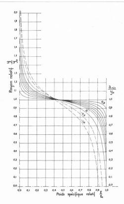
Fig. 17. — Abaque donnant le poids spécifique relatif  $\gamma:\gamma_0$  dans une section quelconque en fonction du rayon relatif  $y:y_0$ , pour différentes valeurs du rayon relatif  $a_{min}:y_0$  de la zone homogène du jet.
