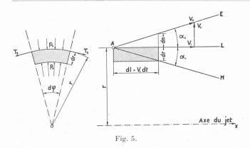
liquide s'échappant du jet en A aura donc une vitesse V<sub>e</sub>, résultante de la vitesse V<sub>1</sub>, dirigée selon la limite du jet théorique AL et d'une vitesse radiale  $V_2$ , due à la turbulence.
