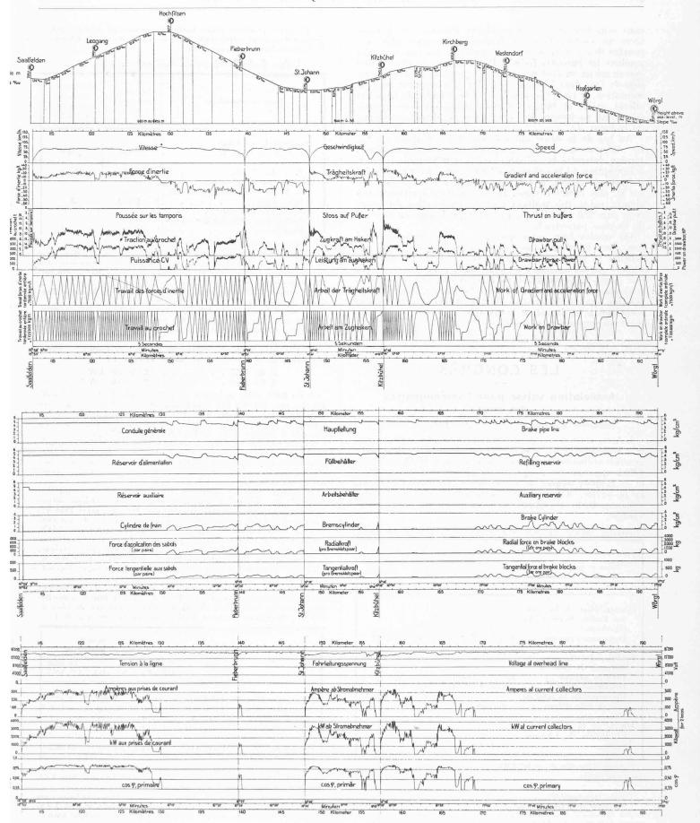
Fig. 23. — Diagrammes du train nº E 131 du 28 juillet 1937 ; deux locomotives nºs 1670.12 et 1670.28,  $2 \times 107$  t, train 365 t, 38 essieux, 10 wagons. (Réduits au  $^{1}/_{8}$ .) Wagon dyn. des Chemins de fer autrichiens.
