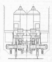
Fig. 22 b). — Locomotive à courant monophasé type 1-D<sub>0</sub>-1 des Chemins de fer autrichiens. Coupe.
