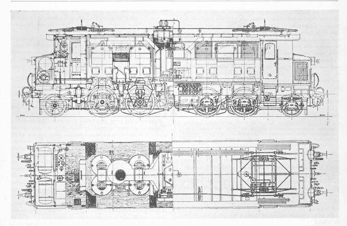
Fig. 22 a). — Locomotive à courant monophasé type 1-Do-1 des Chemins de fer autrichiens. Elévation et plan. — Echelle 1:80.
