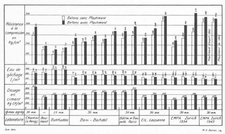
Fig. 1. — Résistance comparée à 28 jours et quantité d'eau de gâchage de bétons avec et sans Plastiment, d'après les essais de différents laboratoires. Chaque béton avec Plastiment (1 % du poids de ciment) était mis en œuvre à la même consistance et par les mêmes moyens que le béton témoin correspondant sans Plastiment.
