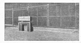
Pont à bascule de 40 ton. pour chemin de fer, avec pont en béton armé, système de leviers sans torsion, couteaux réglables.
