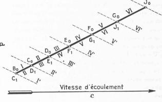
Fig. 4. — Propagation d'une onde de faible amplitude.
