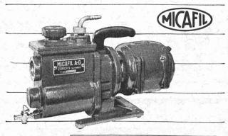
débit à l'aspiration 0,5 à 240 m³/h vide maximum un étage 0,01 mm Hg deux étages 0,001 mm Hg
