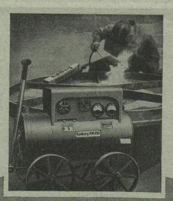
Groupe-convertisseur de soudure à grand rendement Type KW d'un emploi universel, pour les exigences les plus sévères, en particulier pour travaux de soudure dans des conditions difficiles, quand le matériel est rouillé ou lorsque le poste de soudure est très éloigné de la machine.
